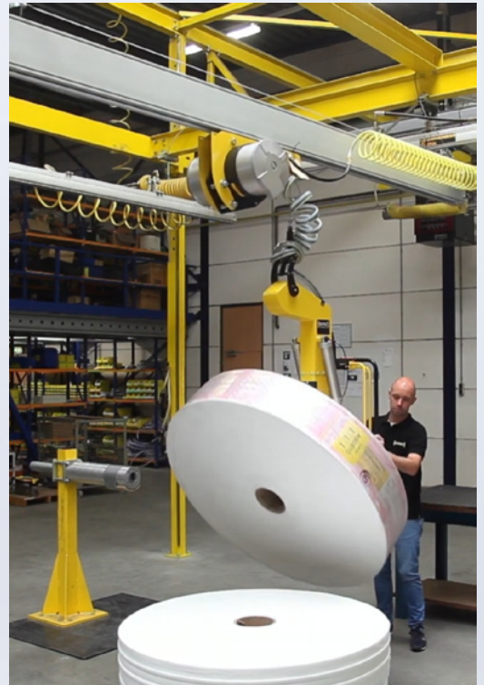
DOTEKs Rollenmanipulator trägt zu mehr Ergonomie und Arbeitssicherheit bei
